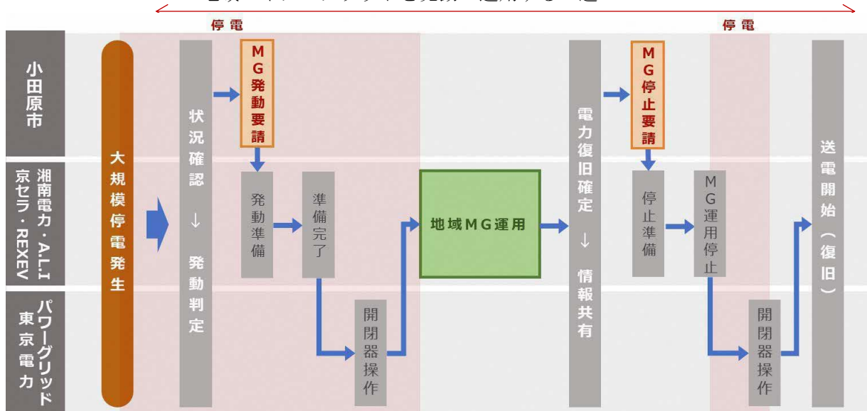
地域マイクログリッドを発動・運用する一連のフロー
